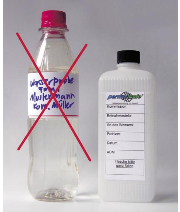
Wasserproben dürfen nur in PE-Probeflaschen oder gut ausgespülten Glas-Mineralwasserflaschen genommen werden
