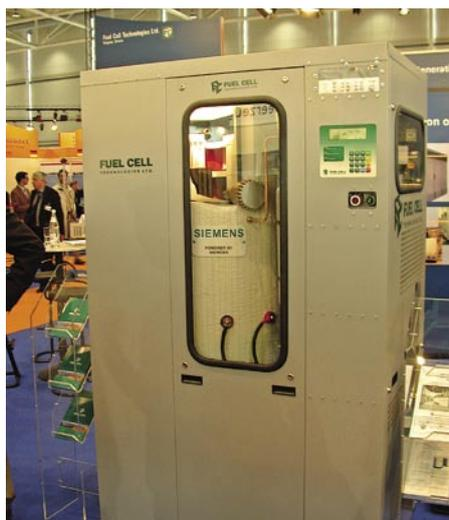
Die Notstromfunktion des BZ-Heizgerätes steht bei dieser Entwicklung von FCT und Siemens im Vordergrund
