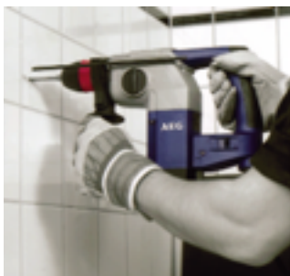
Beim Bohren in empfindlichem Material muss der Schlag nicht abgeschaltet werden – er ist dosierbar
