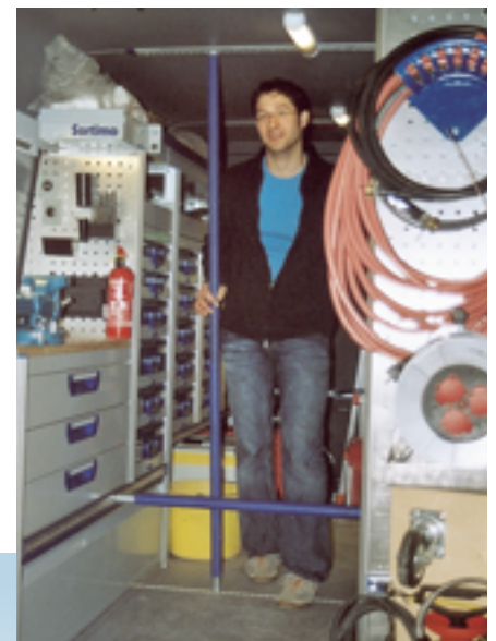
Mit vertikal und horizontal eingesetzten Spannstäben lässt sich Fracht im Mittelgang wirksam stabilisieren
