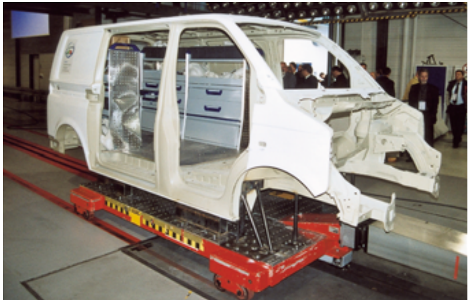
Geknickt und in Falten – aber standgehalten: Die neue Einrichtung Sortimo Globelyst nach dem ECE 44-Crashtest. Durch diesen simulierten Aufprall bei 50 km/h steigerte sich das 550 kg schwere Eigengewicht zur Spitzenbelastung von ca. 11 t
