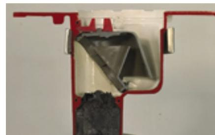
**Bild 3** Brandschutz-Bodenablauf nach dem Brand
