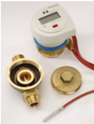
Das Gehäuse des Kapselzählers PolluCom C verbleibt beim Eich-Austausch in der Rohrleitung
