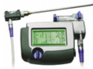
Das Abgasanalysegerät A 500 von Wöhler deckt eine breite Palette von Messaufgaben ab
