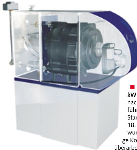
Kombigerät mit hoher Warmwasserleistung, ist ebenfalls in zwei Ausführungen mit Heizleistungen von 16 bzw. 25 kW und Warmwasserleistungen von 24 bzw. 32 kW lieferbar. Die neue Flash-Version bietet eine Heizleistung von 25 kW und eine Warmwasserleistung von 32 kW. Über einen integrierten Edelstahl-Warmwasserspeicher ermöglicht das Flash-System eine Spitzen-Warmwasserleistung von 20 l/min bei 40 °C Auslauftemperatur.
