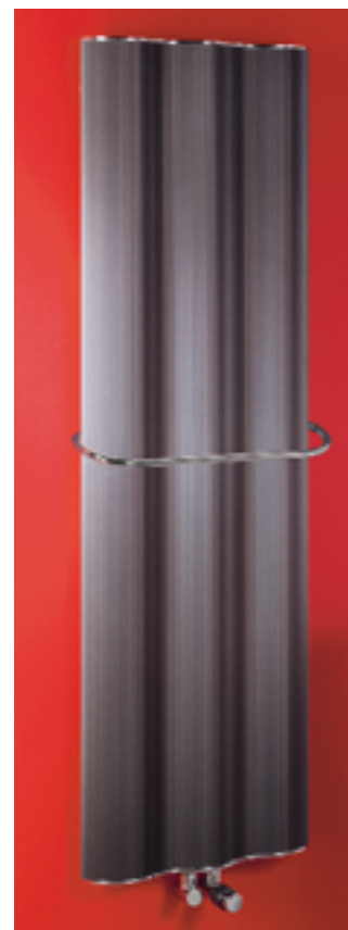
Der Dualis von Zehnder kombiniert einen Stahlkern mit einem wellenförmigen Alu-Strahlungsschirm; für den Badbereich gibt es das Modell Dualis Plus
