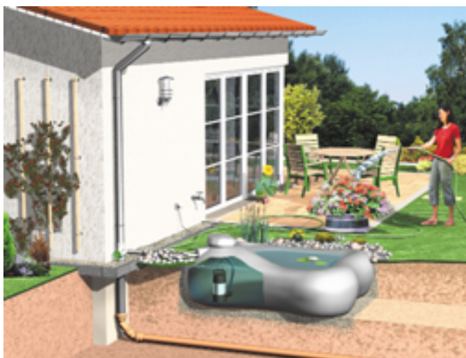
Oben Teich, unten Regenwassertank: eine Lösung, besonders für kleinere Grundstücke
