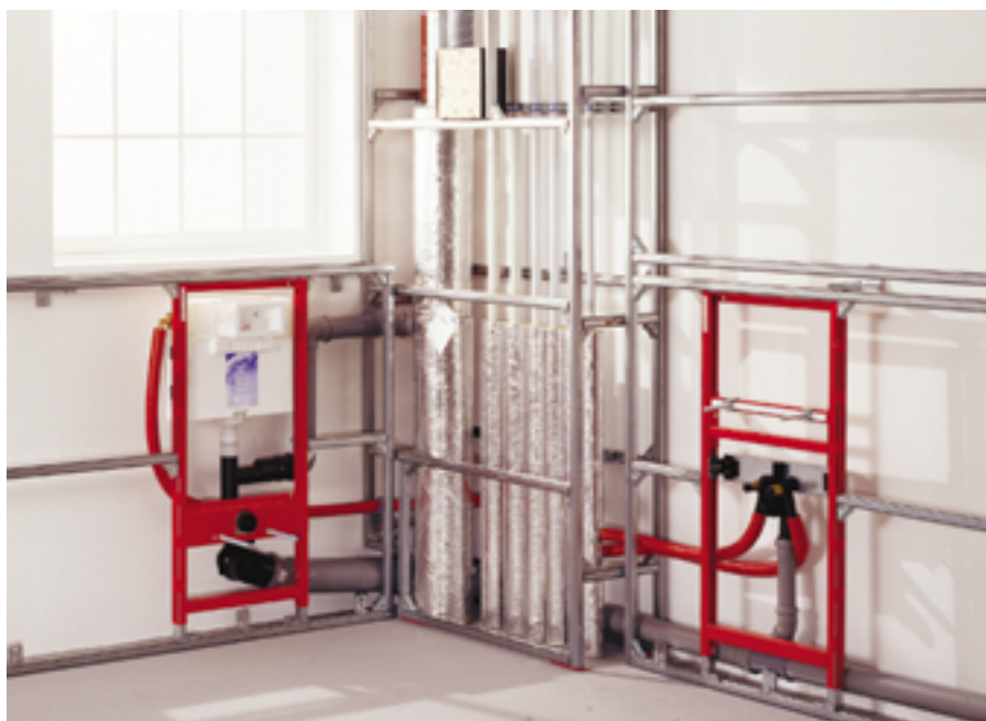
Der DN-70-Anschluss am WC-Modul von Tece ist kompatibel zu gängigen Lüftern. Er passt auf den Zweitraumanschluss von Unterputz-Lüftergehäusen
