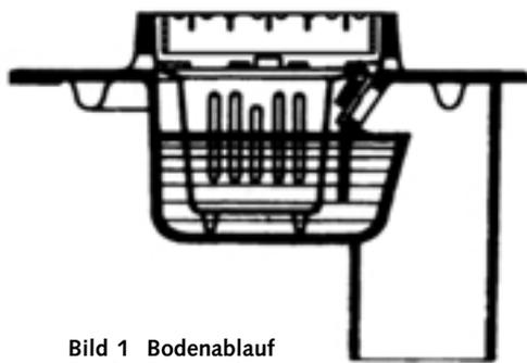
Bild 1 Bodenablauf mit fester Geruchsverschlussstauwand
