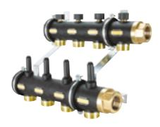
möglicht dabei die Selbstmontage jedes individuell benötigten Verteilers. Dabei sind die Verteilerabgänge zueinander um jeweils 90° drehbar. Die Wärmedämmung des Verteilers wird durch integrierte Luftkammern erreicht, so dass die Bildung von Kondenswasser an der Gehäuseoberfläche vermindert wird. Durch den serienmäßig im Rücklaufsegment eingebauten Durchflussmesser ist ein hydraulischer Abgleich der einzelnen Verteilerkreise möglich, aber auch mit Hilfe der Ventile absperrbar.
