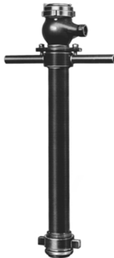
Bild 15 Woltmann-Standrohr-Wasserzähler DN 50 für einen Durchlasswert von 18 \text{ m}^3/\text{h} bei einem Druckverlust von 0,1 bar
