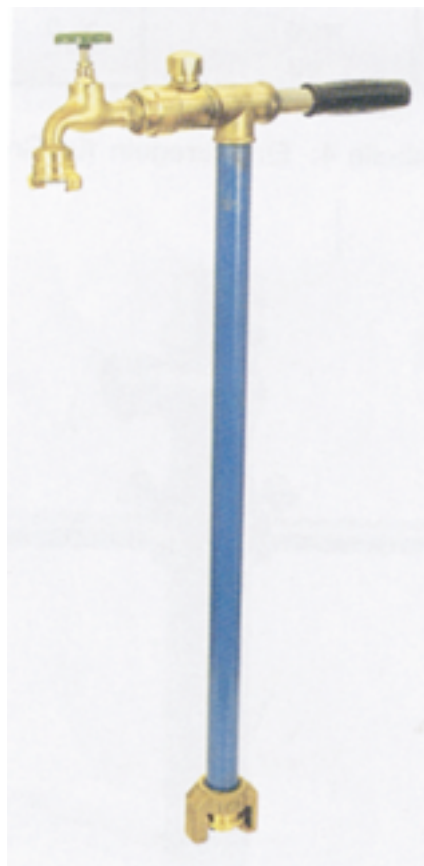
Bild 14 EWE-Gartenstandrohr mit Fußverschraubung 1", geeichtem Wasserzähler Q_n = 2,5 \text{ m}^3/\text{h} , einem Auslaufventil, Einsteck-Rückflussverhinderer, Belüfter und GEKA-Kupplung
