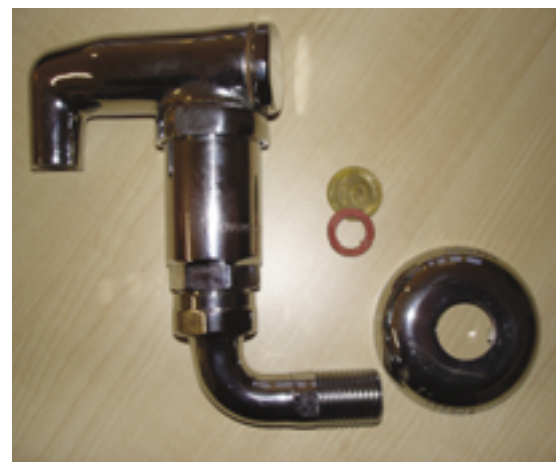
Nicht normgerecht, aber lebensecht: In der Praxis wurden Rohrbelüfter oft mittels Münze und zusätzlicher Dichtung zur Attrappe degradiert
