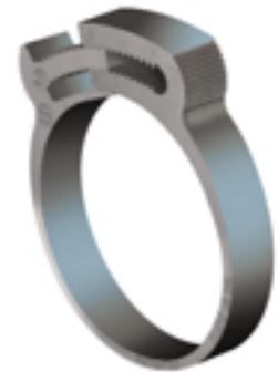
cherheit garantieren sollen. Er wird aus Nylon gefertigt, ist bruchstark und resistent gegenüber den meisten industriellen Lösungsmitteln, Fetten, Ölen, Benzin sowie zahlreichen Chemikalien. Der Clip kann Drücken von bis zu 14 bar und Temperaturen von -40 °C bis hin zu +150 °C ausgesetzt werden. Mit ihm sollen sich Schläuche und Rohre dicht und zuverlässig befestigen lassen und selbst nach vielen Jahren im Einsatz soll er immer noch verstellbar sein.
