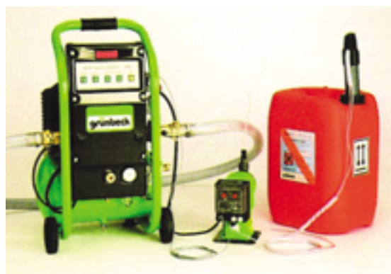
Bild 16 Geno-Spülkompressor mit gleichzeitigem Desinfektionsanschluss über das T-Stück am Kompressor-ausgang – Pumpensteuerung über die Spülkompressor-Elektronik möglich
