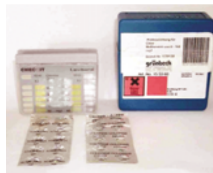
Bild 13 Messbesteck zur Messung von Natriumhypochlorit
