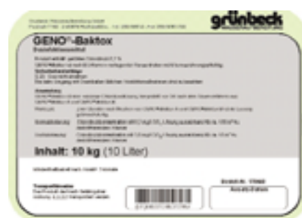
Bild 14 Chlordioxid 0,2 %, Mischung aus Baktiox A und B, Anwendungskonzentration in Rohrleitungen 2 mg/l, Zugabe beim Füllwasser bei Stagnation vor der Inbetriebnahme 0,2 mg/l
