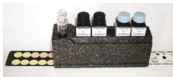
Bild 15 Messbesteck zur Messung von Chlordioxid
