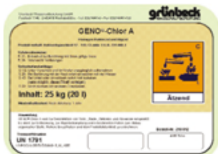
Bild 12 Natriumhypochlorit, Anwendungskonzentration in Rohrleitungen 50 mg/l
