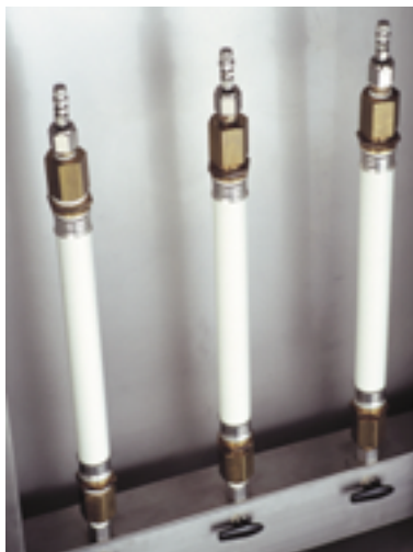
Auf der Hewing-Prüfanlage werden die Rohre einer Belastung von bis zu 200 bar ausgesetzt
