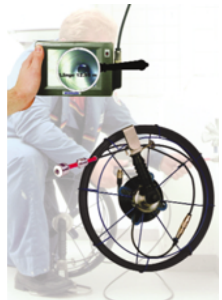
Um Schadensfälle zentimetergenau zu orten kann eine digitale Metrierung hilfreich sein (VIS – Meter.jpg)
