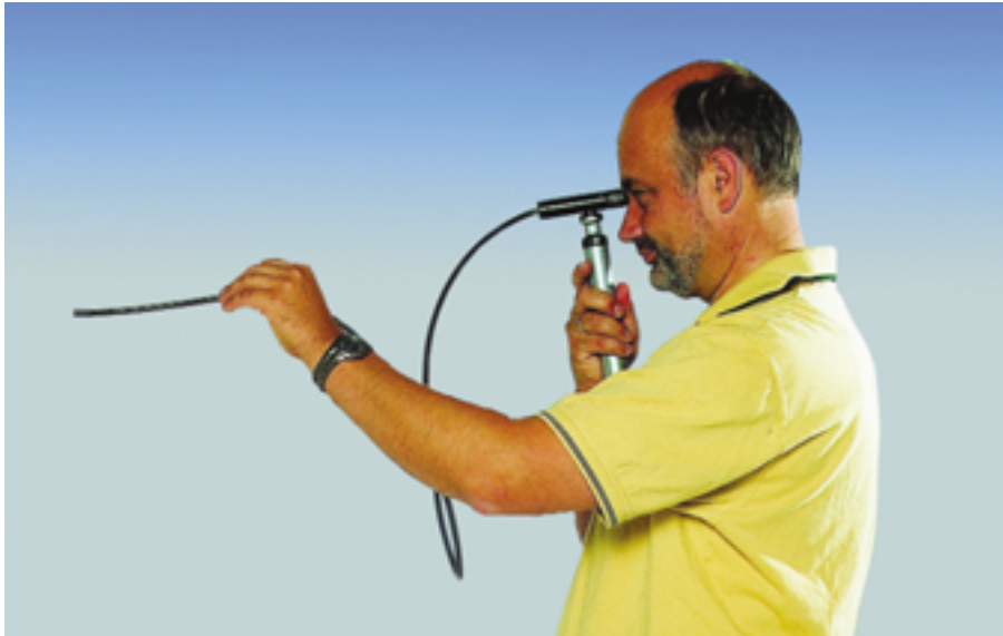
Glasfaser-Endoskope besitzen eine biegsame Sonde mit einem Außendurchmesser von nur 8 mm
