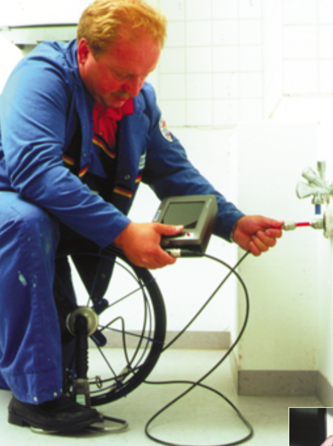
Mit dem Videinspektionssystem VIS 2000 mit Miniaturkamerakopf und Haspel können z. B. Abwasserleitungen ab 40 mm Durchmesser kontrolliert werden
