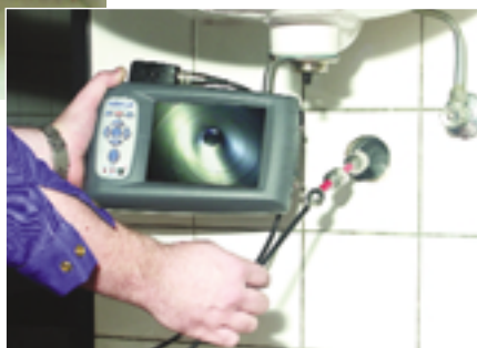
Mit dem Videinspektionssystem VIS 2000 mit Miniaturkamerakopf und Haspel können z. B. Abwasserleitungen ab 40 mm Durchmesser kontrolliert werden
