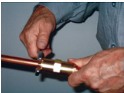
**Bild 5 Montage:** >B< Oyster Übergangskupplung und Kompensator werden zusammengesraubt
