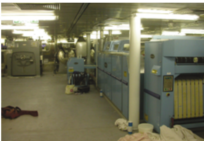
Die Bordwäscherei wird mit dem Kondenswasser aus der Klimaanlage betrieben
