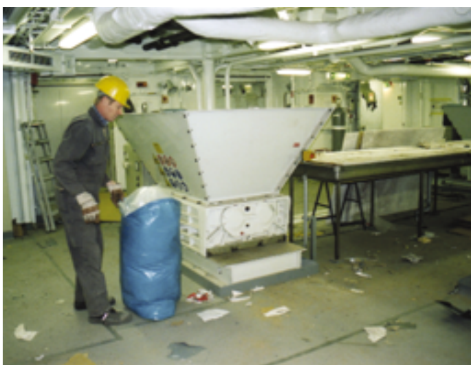
Die Abfallschredder hatten beim Klar-Schiff-Machen am Ausrüstungskai der Werft schon gut zu tun
