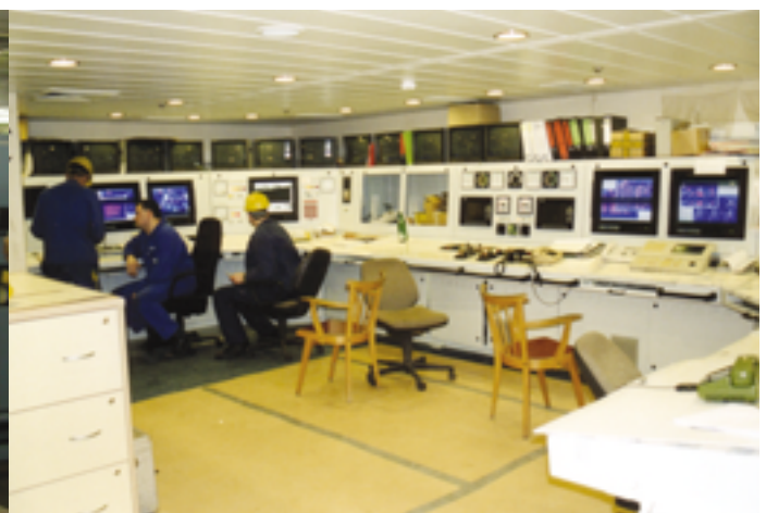
Die „heimliche Kommandobrücke“ des Schiffes: von hier aus wird die gesamte Schiffstechnik überwacht und gesteuert
