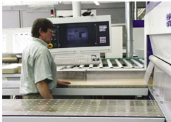
**Vernetzt:** Die Plattensäge in Greding erhält ihren Schnittplan von einem PC, der über das interne Netz mit dem Fertigungs-Leitrechner verbunden ist. Letzterer hat den direkten Draht zum zentralen Server, der die Produktions-Planung und -Steuerung von Bad Fredeburg aus organisiert
