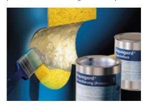
Nach Herstellerangaben dringt die Grundierung tief in die Kapillaren und Luftbläschen des Betons ein und verschließt diese dauerhaft und wasserdicht. Darüber hinaus würde der Speziallack die Oberflächen der Kernbohrungswandung versiegeln und gleichzeitig eventuell angeschnittenen Bewährungsstahl vor Korrosion schützen.
