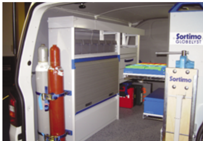
Das Globelyst-System von Sortimo ist nicht an vorgegebene Rastermaße gebunden
