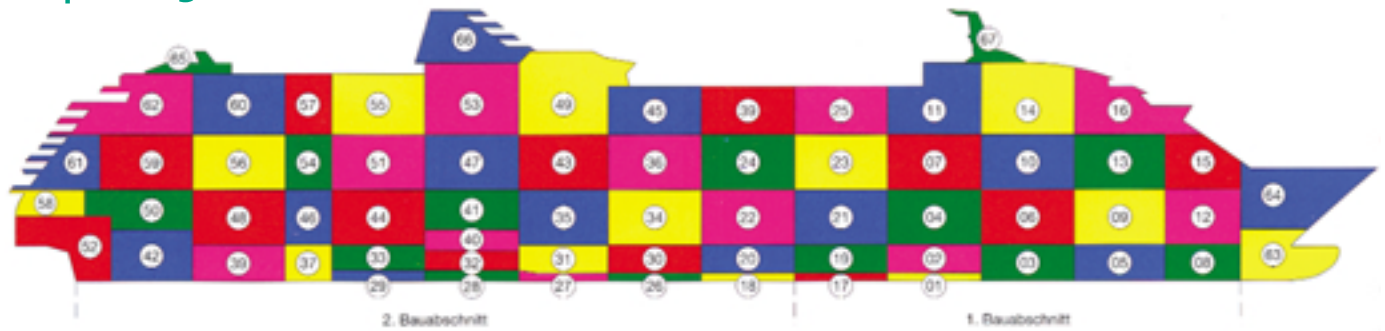
Die einzeln vorbereiteten Blöcke werden nach einem Blockplan Stück für Stück zu einem Schiff zusammengesetzt
