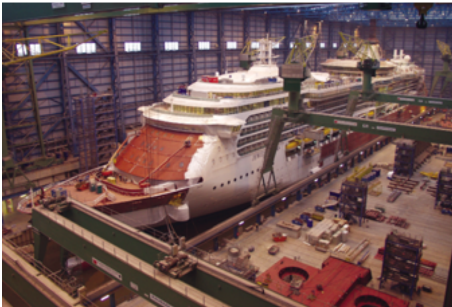
In den riesigen Baudocks der Meyer-Werft entsteht dann Block für Block der Rohbau eines neuen Luxusliners
