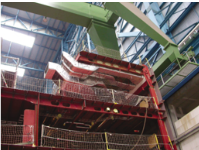
...wenn dann aus den Decks Sektionen und Blöcke entstehen, sind die Leitungen schon eingebaut
