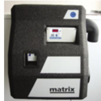
Das kompakte Modul benötigt einen Flächenbedarf von 0,21 m<sup>2</sup> und wiegt 22 kg. Die Frischwassernachspeisung und Pumpenleistung sind auf 60 l/min ausgelegt. Pumpe und Welle sind aus Edelstahl gefertigt, während das Motorlager aus Aludruckguss sowie die Lager aus Graphit/Keramik bestehen.
