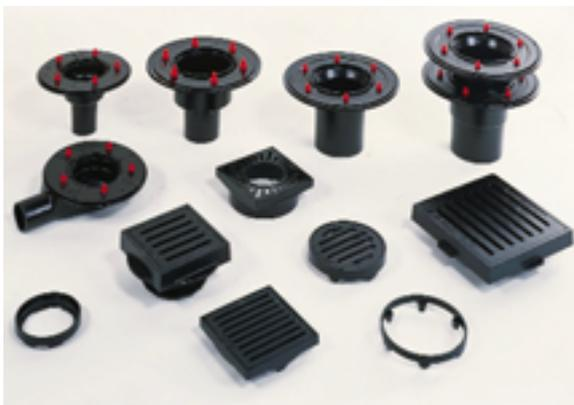
**Bild 4 Das neue Ablaufprogramm von ACO Passavant ist auf die gesteigerte Abflussleistung der Regenwasserfallleitungen gemäß DIN EN 12056-3 abgestimmt. Das Baukastensystem besteht aus Abläufen DN 70, 100, 125 und 150**
