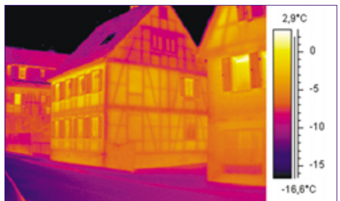
Selbst das alte Fachwerk unter dem Mineralputz wird durch Infrarot-Thermografie sichtbar
