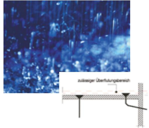
Gravierende Änderungen bei Normung und Rechtsprechung erfordern auch ein verändertes Planungsverhalten. Durch den Einsatz von optimierten Flachdachabläufen können bei Freispiegel-Entwässerungsanlagen die Nennweiten reduziert werden
