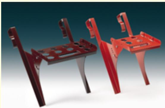
Dabei sind die Konsolen variierbar und erlauben den Einsatz jeglicher Profilierungen des Bedachungsmaterials. Die Sicherheitstritte gibt es in 18 und 28 cm Breite, sie entsprechen der DIN EN 516 Klasse 1, DIN 18160-5 sowie der Ö-Norm B 8207. Die Sicherheitsdachhaken werden aus verzinktem Stahlblech gefertigt und sind in den Variationen verzinkt, Rot, Dunkelbraun und Schwarz für die Ausführungen Schiefer, Biber, profilierte sowie ebene Betondachsteine und Tondachziegel erhältlich.
