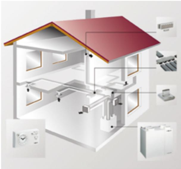
**Bild 6 Die verschiedenen Komponenten einer zentralen Wohnungslüftung**
