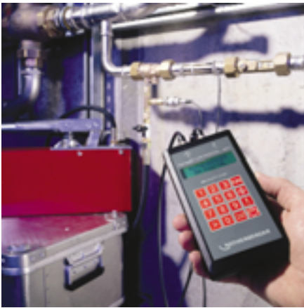
Bild 7 Digitales Dichtheitsprüfsystem mit Drucker für die Medien Druckluft und Wasser
