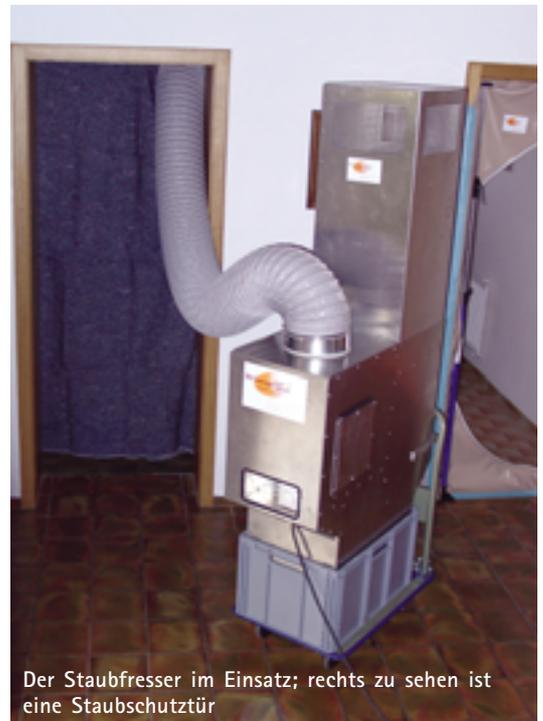
Der Staubfresser im Einsatz; rechts zu sehen ist eine Staubschutztür
