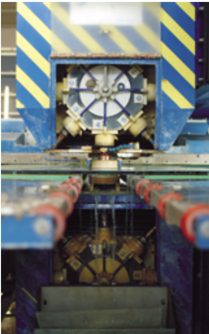
Auf der computergesteuerten CNC-Maschine erfolgen die serienmäßigen Standardbohrungen. Acht verschiedene Bohrköpfe stehen über und unter der Scheibe zur Verfügung, denn auch hier muss wieder von beiden Seiten gebohrt werden, damit die Scheibe beim Bearbeitungsvorgang nicht ausbricht
