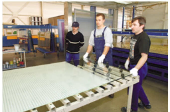
Vorsichtig wird die bedruckte Scheibe auf ein Rollenband gelegt, auf dem sie die Trocknungsanlage durchläuft
