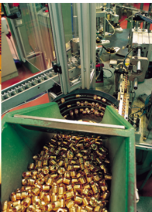
Messing-Bauteile werden zur Weiterverarbeitung von der Zuführstation auf die vollautomatische Fertigungsinsel transportiert
