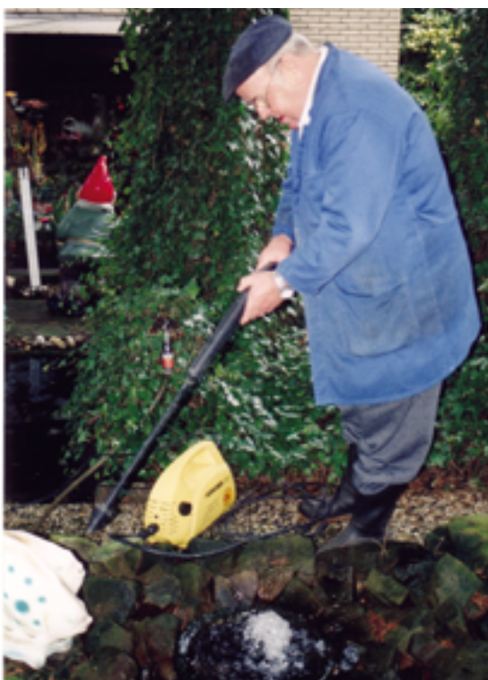
Kommt ein Hochdruckreiniger zum Einsatz, muss dieser über einen Rohrtrenner EA3 mit Wasser versorgt werden
