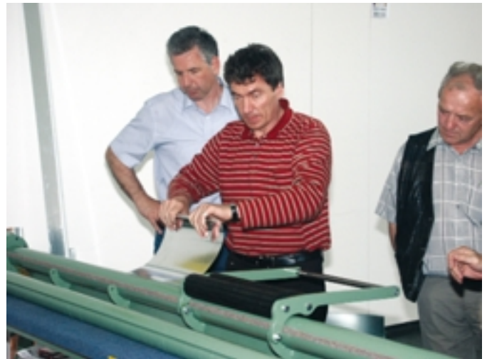
Vladimir Furjanic (Lima Maschinenbau) demonstriert das Vorrunden von Blechen an einer neu entwickelten Maschine
