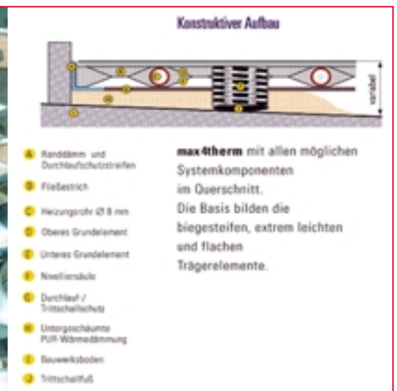
Grundaufbau des Fußbodenheizsystems „Max4therm“, das es in den Ausführungen FS 10 und FS 20 gibt
