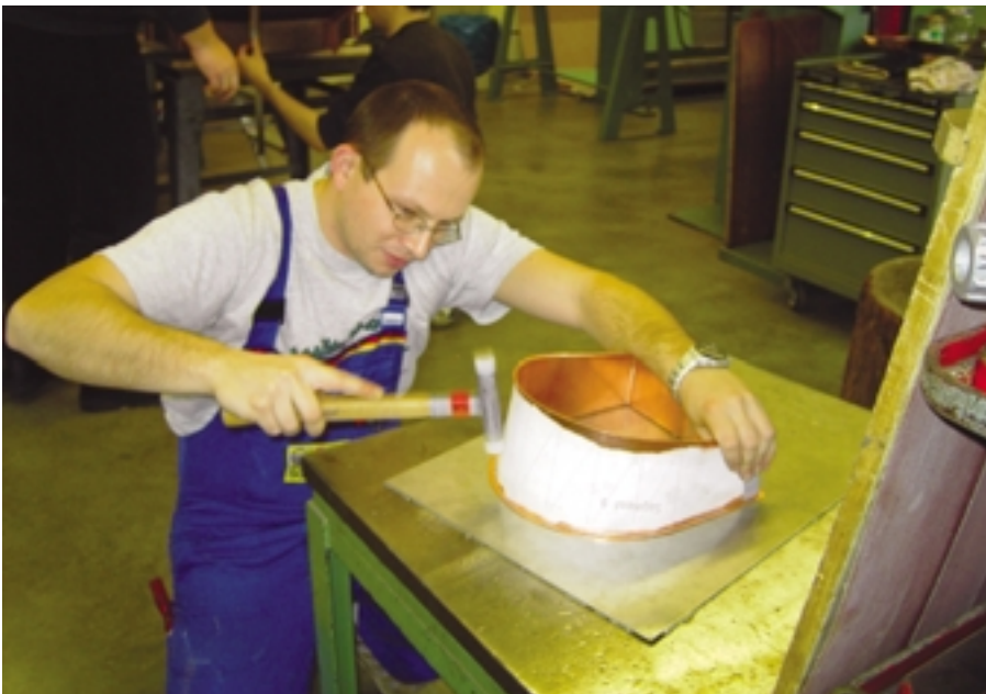
Planrichten des Abschlusssegmentes auf einer Edelstahlunterlage
