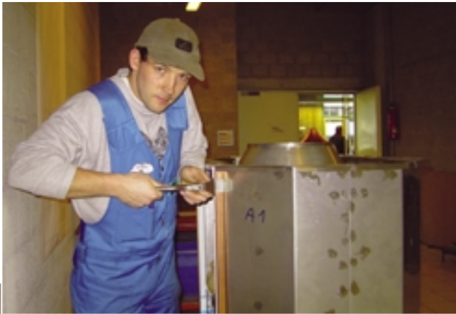
Deutlich sichtbar auf der Edelstahl-Unterkonstruktion sind die Abdrücke der Punktschweißnähte
