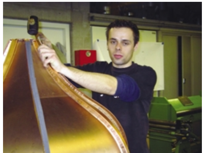
Konzentration beim Aufschieben der 0,7 mm dicken Kupferleiste
