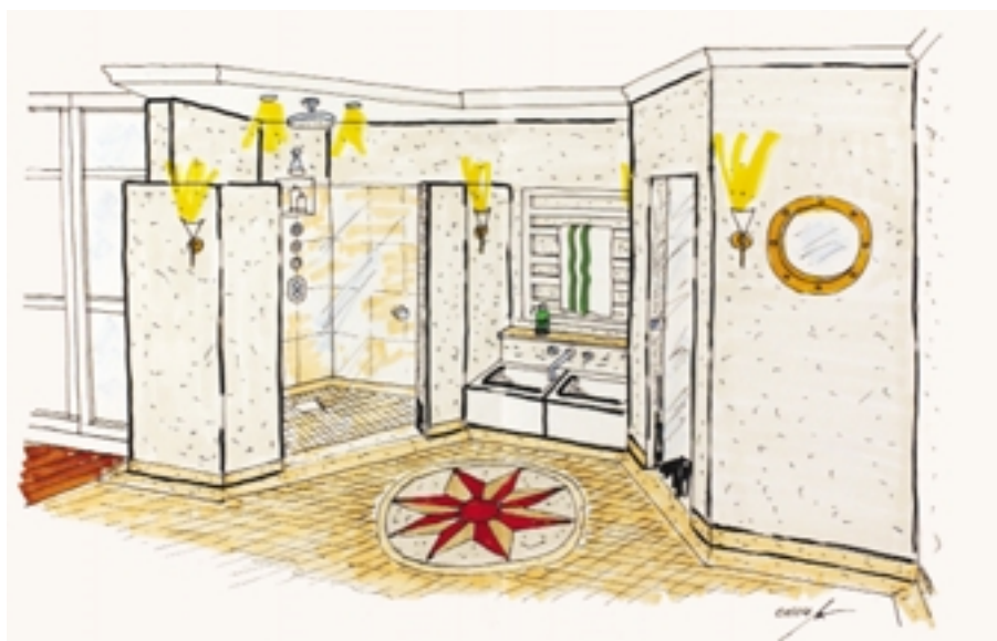
Der Estrich im Badezimmer muss neu eingebracht werden, um eine bodenebene Duschwanne und einen schwellenlosen Eingang zur Dampfduche zu erhalten. Über das Original-Messing-Bullauge im neuen Dampfbad wird sich Karl-Heinz besonders freuen
