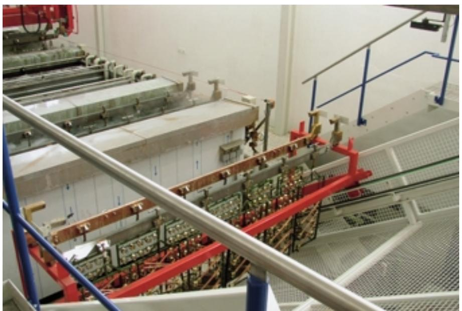
Im Zuge der Modernisierung wurden neue Umsetzer und Hubstationen am Fördersystem installiert
