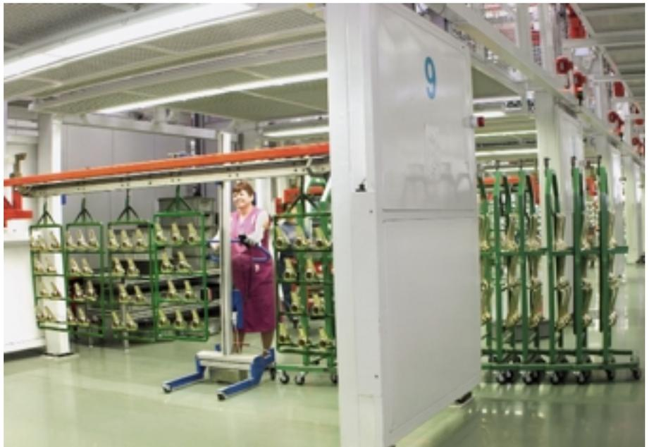
Die automatische Förderanlage wurde demontiert und durch eine manuelle Bestückung der Warenträger mit den Gestellen ersetzt
