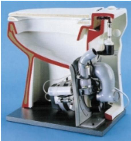
Eigenheimen oder Wohnmobilen konzipiert. Es fördert alle Abwässer mit einem Druck von einem bar durch ein 28–32 mm dünnes Rohr. Auch Strecken zum Kanal oder Sammelabfluss werden bis zu 5 m hoch oder 60 m weit bewältigt. Ermöglicht wird dies durch ein unsichtbares, in die Keramik integriertes,
