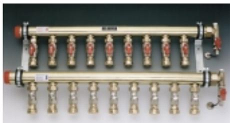
Erhältlich ist er von 13 bis 20 Gruppen für den Rohranschluss  $25 \times 2,3$ . Verteiler und Sammler sind aus Messingrohr mit Entlüftungsventil und KFE-Hahn gefertigt.
