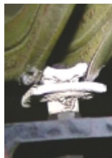
Versagen: Ausriss Schienenmutter in Verbindung mit Aufwölbung Schienenlippen
