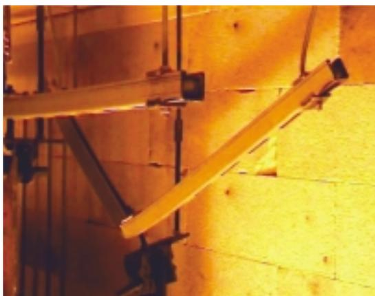
Bild 2 Abgehängtes System nach Brandbeanspruchung
