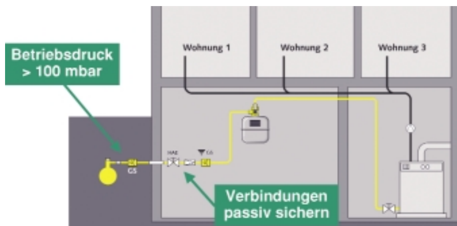
Bild 6 Bei Betriebsdrücken in der Hausanschlussleitung von mehr als 100 mbar müssen lösbarere Verbindungen im Gebäude, die vor dem ersten Strömungswächter im Haus liegen, passiv gesichert werden
