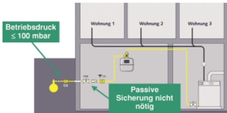
Bild 7 Wird die Hausanschlussleitung mit Drücken von nicht mehr als 100 mbar betrieben, kann auf die passive Sicherung lösbarer Verbindungen verzichtet werden
