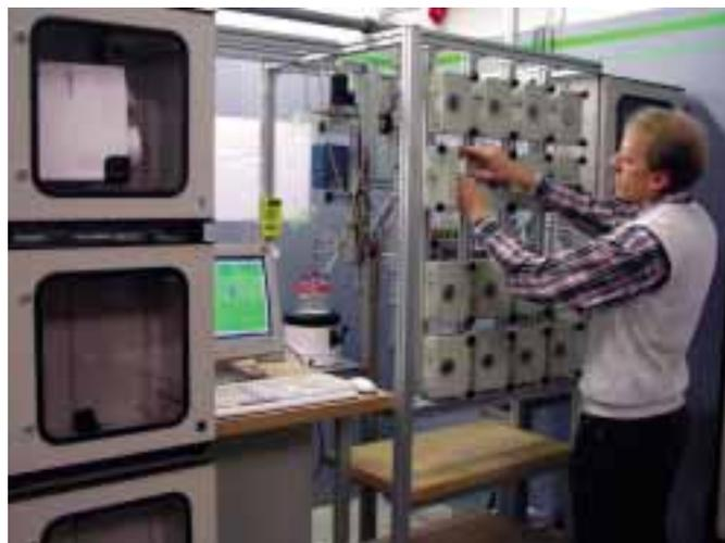
Die Sensoren werden vor ihrem Einsatz mit einem speziell dafür entwickelten Prüfstand kontrolliert
