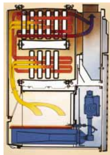
Bild 4 Moderne Verbrennungstechniken macht auch vor Öfen und Kaminen nicht halt, wie an diesem Gas-Heizeinsatz für Warmluftkachelöfen deutlich wird
