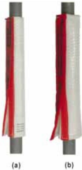
Bild 9 Brandschutz-, Körperschall- und Wärmedämmung BSM-S (a), BSM-S 13 (b), Baulängen 250 und 400 mm, Dämmdicken 4 und 13 mm
