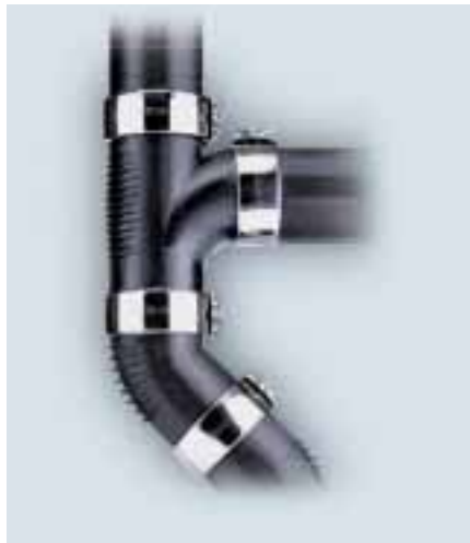
Bild 3 Die angeformten „Rippen“ an den Formteilen sind Schwingungsdämpfer, die zu verbesserten Schallschutzwerten führen
