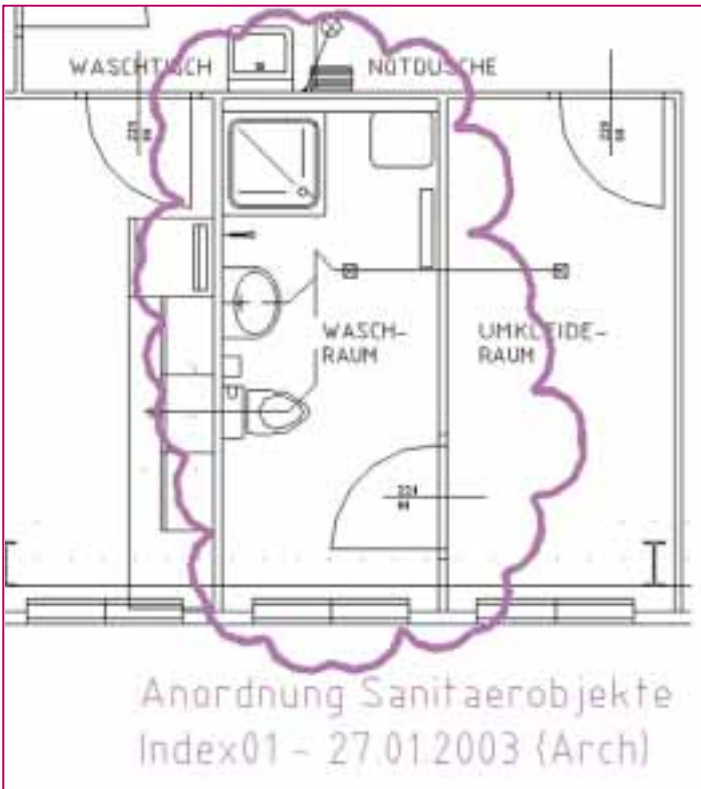
Bild 5 What's new? „Revisionswolken“ zur Kennzeichnung von Planänderungen
