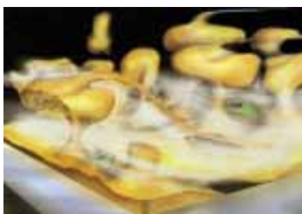
Bild 3 Biofilm mit einheitlichen oder gemischten Mikroorganismen im Bereich von Kalkablagerungen und Rost als Untergrund bei Stahlrohren
